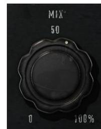
0% に設定するとドライシグナルのみを出力し、100% に設定すると処理後のウェットシグナルのみを出力します。50% に設定するとドライとウェットシグナルの等しいブレンドが出力されます。バランスはコントロール全体で連続的に可変可能です。
