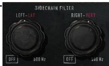
サイドチェイン・フィルター (左/ラテラル、右/バーチカル・チャンネルごとに各 1 つ) は、コンプレッサーのサイドチェイン・シグナル上のローカットフィルターのカットオフ・フリークエンシーをコントロールします。これらは、1 オクターブ当たり 12 dB のスロープを持ち、20 Hz ~ 500 Hz の間の周波数とオフを選択可能です。デフォルトではオフに設定されています。
