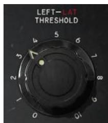
チャンネルに適用するコンプレッション量を決定します。より多くのコンプレッションを行いたい場合は、時計回りに回してください。(コントロールを上げるとスレッシュホールドが下がる)
